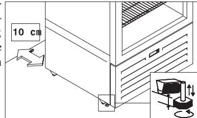
**Achtung!** Der Abstand von der Mauer muß **mindestens 10 cm** betragen. Das Gerät muß auf einem ebenen Boden (die Füße regulieren), und fern von Wärmequellen (Heizkörper, Öfen usw.) aufgestellt werden und darf nicht Sonnenstrahlen ausgesetzt werden.
