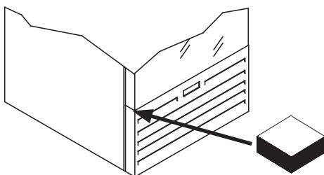
Dopo l'installazione, rimuovere il tassello di legno sotto la porta montato per evitare cedimenti del telaio durante i trasporti. Reinserirlo ogni qualvolta l'apparecchio viene trasportato.
