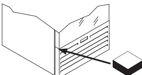
Zwischen der Glastüre und dem Wagen muß ein Holzplock eingeführt werden, der ein Rahmensenkung während der Transporte vermeiden. Bei jedem Transport ist Holzplock wieder zu positionieren.
